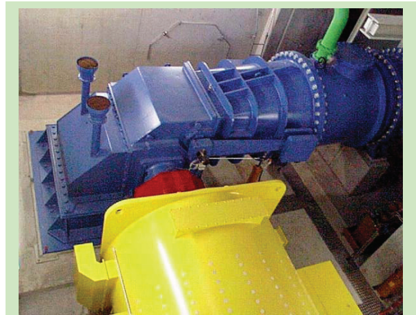
Bild 1: Schluchsee, H = 33,6 \text{ m} ; Q = 4,68 \text{ m}^3/\text{s} ; N = 1\,442 \text{ kW} ; n = 214,3 \text{ U/min} .
